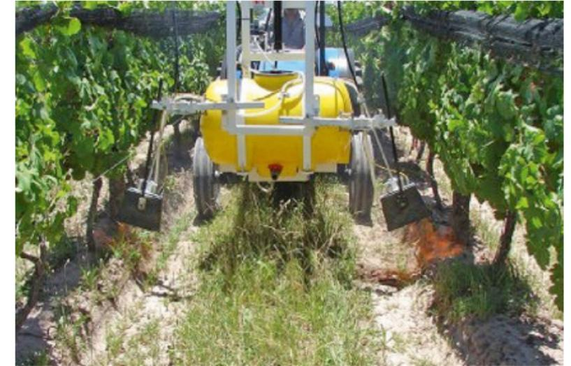
Figura 7. Flameador manual (izq.). Tractor equipado con flameadores (der.), tomado de Uliarte et al., (2011).
